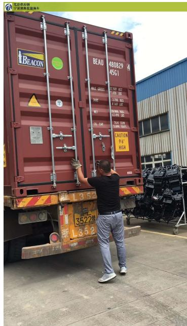
集装箱拖车的集装箱的内部尺寸的定义的国家标准集装箱集装箱的内部的较大长、宽、高尺寸。因为他的一个高度是箱底板面到箱顶板的下面的一个距离，宽度是两内侧衬板之间的一个距离，长度是箱门内的侧板量到端壁的内衬板之间的距离。它决定集装箱的内容积和箱内的货物的较大尺寸。主要的尺寸有外尺寸是二十x8x8英尺六英寸，就是叫做二十尺货柜，也就是内径：5898\*2352\*2390毫米，还有2.40x8x8英尺六英寸，也就是四十尺货柜，就是内径12024\*2352\*2390mm
